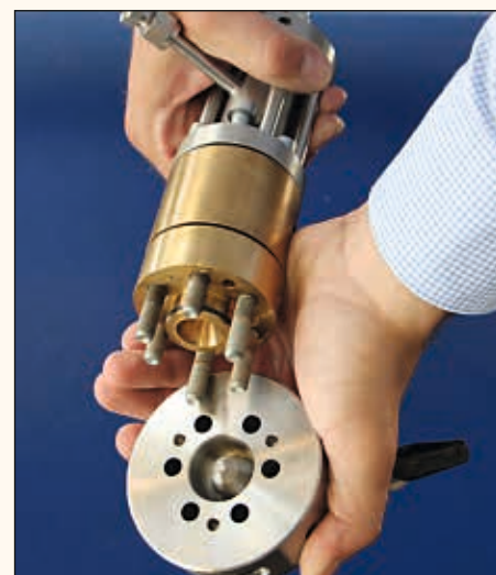
Effektiviteten til et anlegg kan bedres på ulike måter. En ejektor som vist på bildet kan bidra til reduserte tap ved gjenvinning av kinetisk energi fra trykkreduksjon i anlegget. Foto: Christina Benjaminsen
