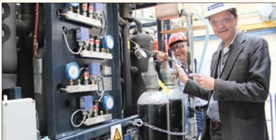
Nye konsepter krever utvikling av nye løsninger. Her viser Petter Nekså (t.h.) og Michael Bantle fram en testrigg som har muliggjort effektiv varmepumpedrift for høye omgivelsestemperaturer. Foto: Christina Benjaminsen
